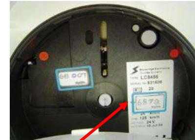
Место установки заводской таблички внутри устройства
